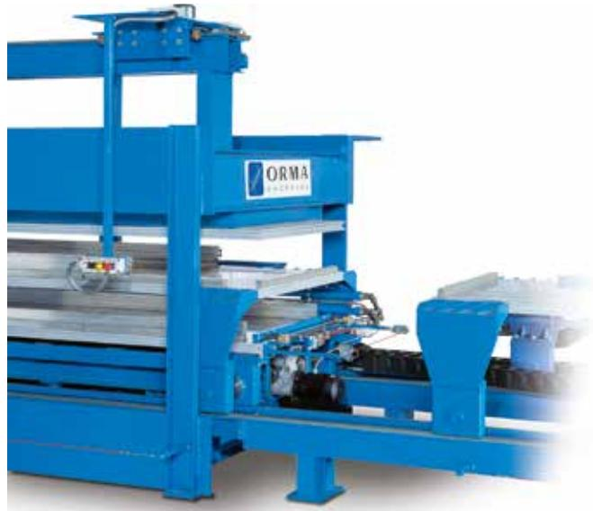
■ Particolare del carrello motorizzato porta testa di schiumatura.
