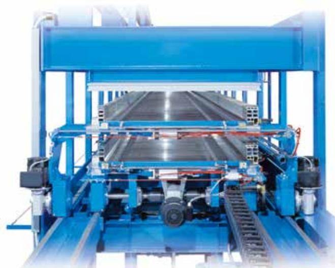
■ Vista frontale della presa 2+2 a piani motorizzati. In questa immagine possiamo notare: i profili di alluminio componibili montati sui piani per il contenimento laterale del poliuretano e il sistema di motorizzazione dei piani stessi.
