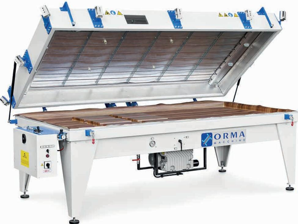
Macchina adatta per il rivestimento di ante sagomate con PVC. Con la versione base si deve utilizzare il foglio completo di PVC per poter permettere il ciclo del vuoto. Come optional è possibile richiedere e montare il Kit di aggancio della membrana.
