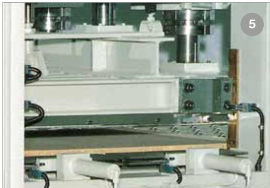
Particolare del sistema di pressata laterale per LS (optional regolazione in altezza).
