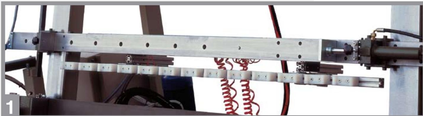
**1** Particolare dell'accessorio denominato "barra orizzontale supplementare completa di pistone e controbattuta" necessario nel caso finestre con traversi centrali.
