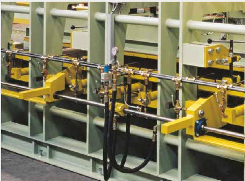
Particolare del gruppo di pressata laterale con possibilità di regolazione in altezza.
